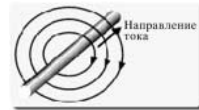
Рисунок 1.3. Магнитное поле, создаваемое проводником с током
