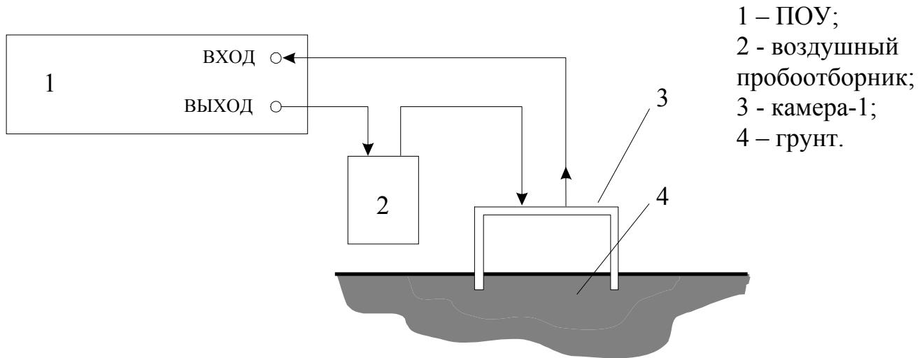
Рис. 1а. Схема 1 отбора пробы воздуха для определения ППР.
