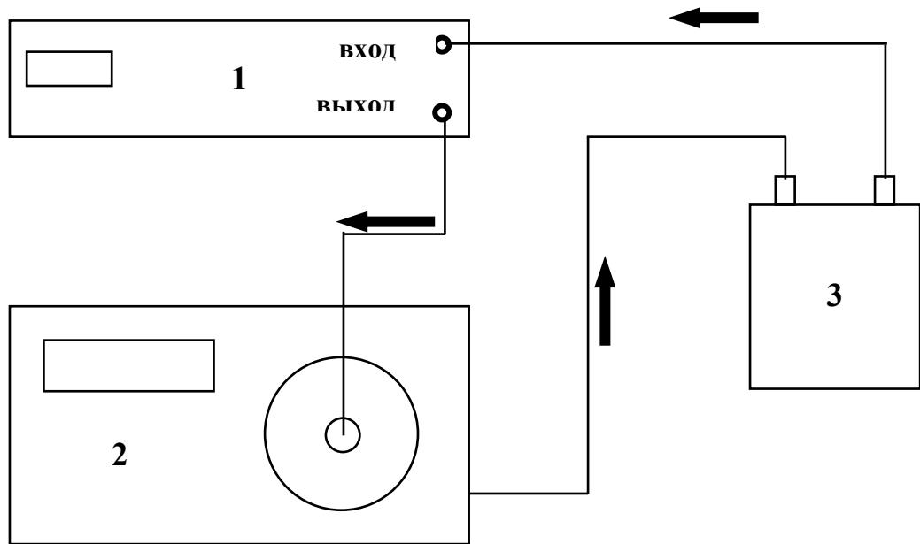
Рис.2. Схема перевода пробы в радиометр.
