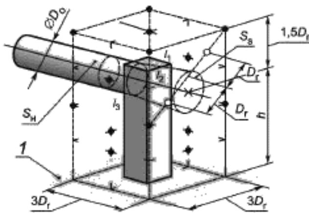
1 — звукоотражающий пол или стена; 2 — звукоотражающая плоскость;
