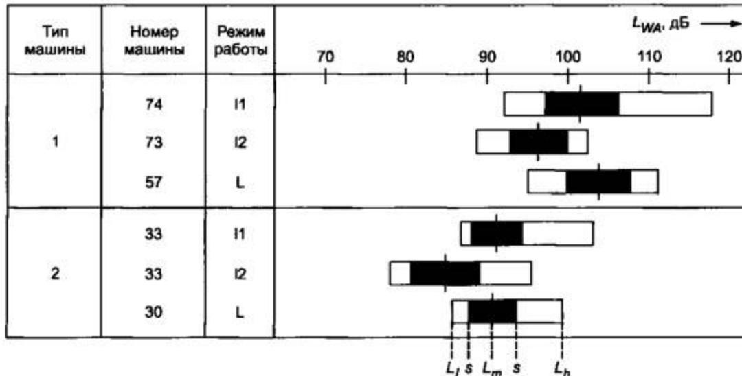
11 - режим холостого хода при максимальной скорости; 12 - режим холостого хода при номинальной скорости; L - нагрузка при заданном режиме работы с рабочим инструментом; s - стандартное отклонение;  $L_l$  - наименьший уровень;  $L_m$  - средний уровень;  $L_h$  - наибольший уровень
