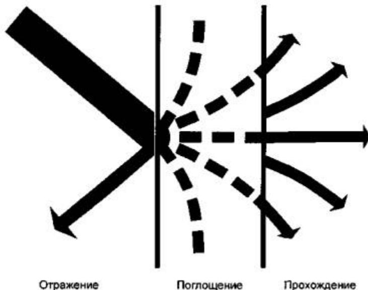
**Примечание** - Соотношение между падающим на ограждение или стену звуком, отраженным от нее, преобразованным в тепло (поглощенным) и прошедшим сквозь стену. Звукоизоляция стены определяется соотношением падающего и прошедшего звука.
