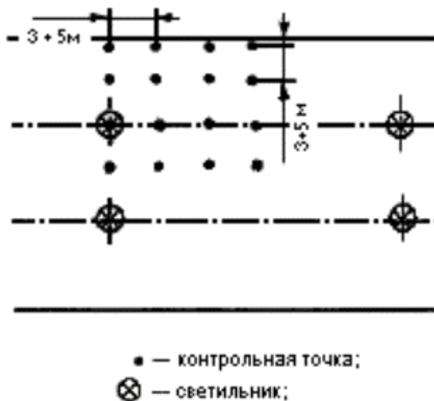
Рисунок А8 - Расположение контрольных точек при измерении средней освещенности улиц при осевом двухрядном расположении светильников
