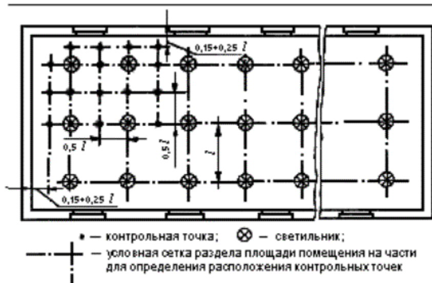
Рисунок А1 - Расположение контрольных точек при измерении минимальной освещенности помещения от светильников, принимаемых за точечные излучатели
