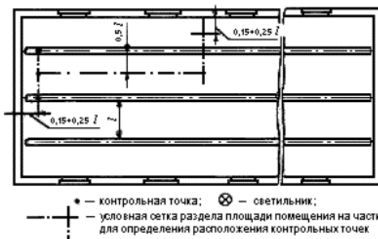
Рисунок А2 - Расположение контрольных точек при измерении минимальной освещенности помещения от светильников, принимаемых за линейные излучатели
