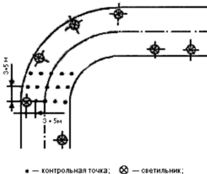
Рисунок А10 - Расположение контрольных точек при измерении средней освещенности улиц в местах закругления
