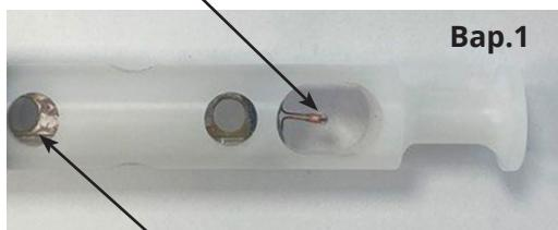
Датчик температуры и относительной влажности воздуха
