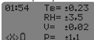
Повторное нажатие на кнопку «Выбор» осуществляет переход к отображению на экране измерителя единиц измерения физических величин (см. п. 6.5), например:
