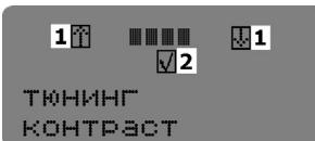
Стрелки (1) указывают на возможность изменения контрастности экрана с помощью кнопок «Вверх» и «Вниз» на клавиатуре.
