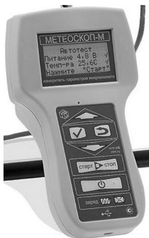
**Рисунок 6.** Измерительно-индикаторный блок
