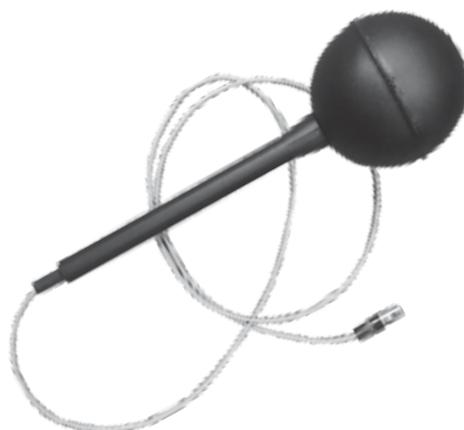
**Рисунок 5.** Шаровой термометр
