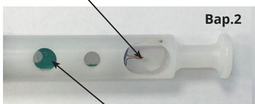
Датчик температуры и относительной влажности воздуха
