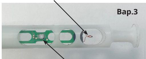
Датчик температуры и относительной влажности воздуха
