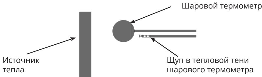
**Рисунок 8.** Относительное расположение измерительной аппаратуры и источника излучения.
